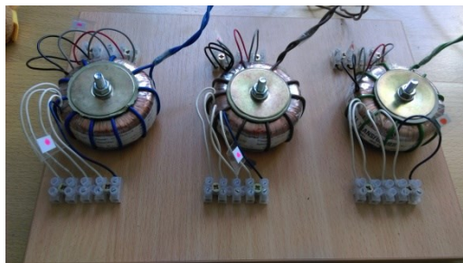
Slika 3 Fotografija torusnih transformatora korišćenih u eksperimentalnom postupku
