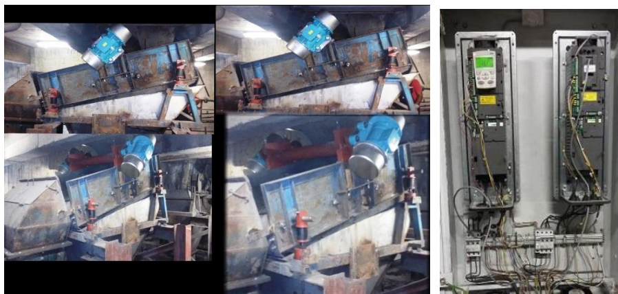
Slika 6. Prikaz realizovanih frekventno regulisanih pogona vibracionih sita na TENT-B
