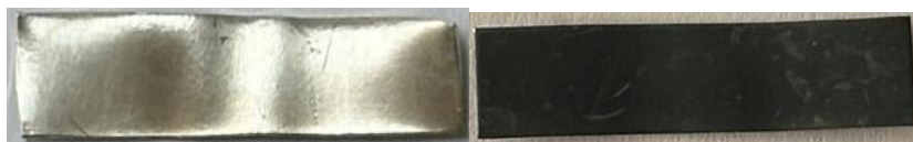
Slika 4. Srebrna pločica pre i nakon eksperimenta na 150°C
