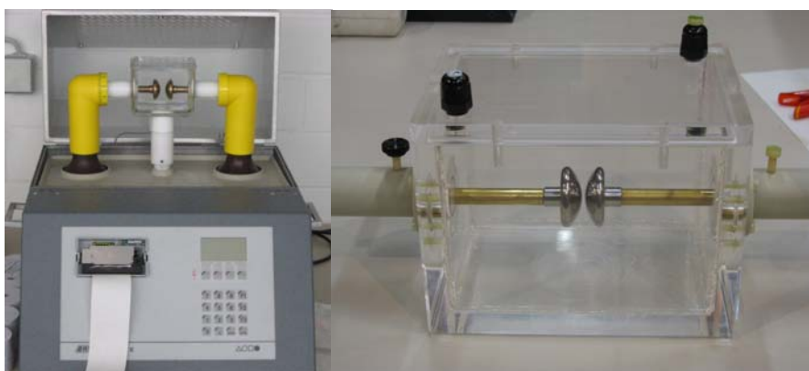
Slika 1. Baur DTA 100 E tester ulja (levo) i pleksiglas test ćelija (desno)
