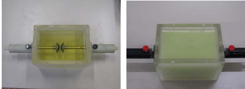
Slika 2. Merna ćelija sa Lyra X uljem (levo) i FR3 uljem (desno) na temperaturi od -25\text{ }^{\circ}\text{C}
